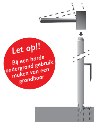
Figuur 2: Sla de grondbuis, na plaatsing van de slagpen, stevig in de grond. (met Anti-rotatie pin)
