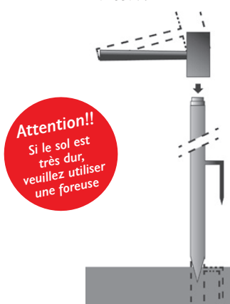
Image 2 : Enfoncer la base du pied dans le sol à l'aide d'un marteau.
